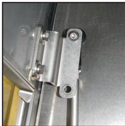
Abb. 5-4 Leddstang oppe etter ombygging
